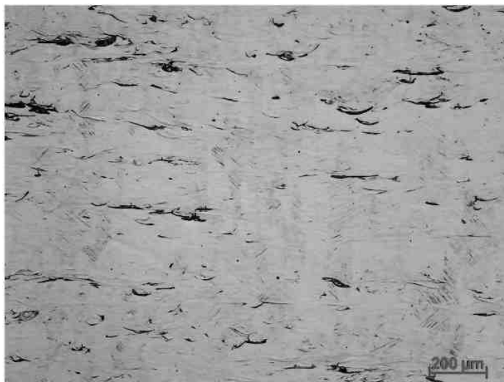
Рисунок 1 – Поперечное сечение протравленного реактивом Кролла легированного in-situ образца L-PBF Ti6Al4V ELI – 1,38 мас.% Cu. Темным цветом показаны области, богатые медью (подтверждено анализом SEM-EDS) [4]
