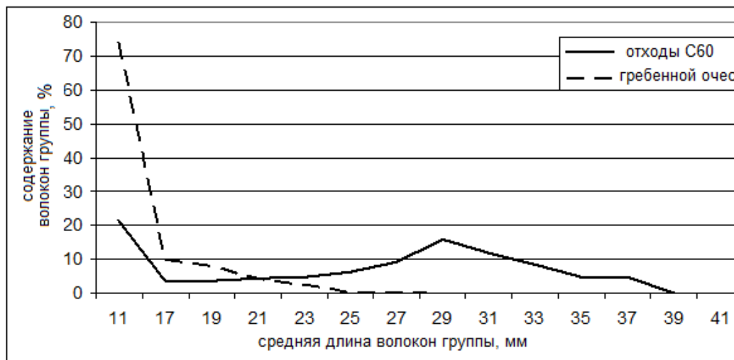
Рисунок 1 – Распределение волокна в очесе с гребнечесальных машин Е66 и с чесальных машин С60 по классам длины
