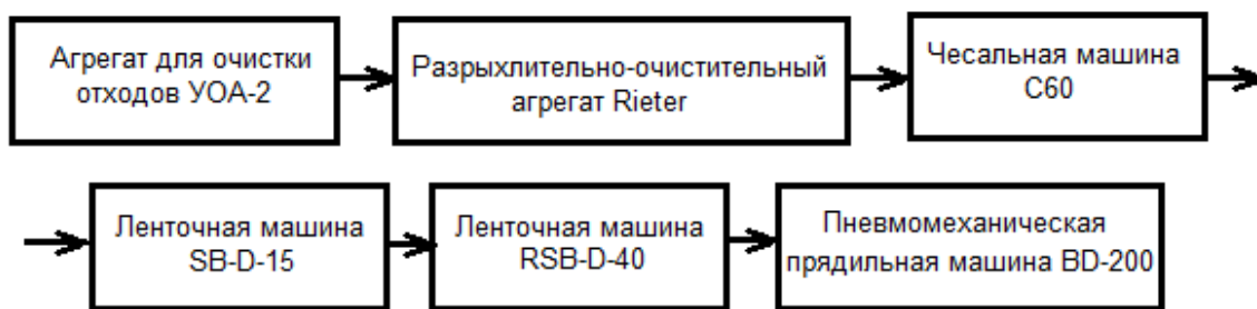
Рисунок 2 – Технологическая цепочка для получения пряжи из отходов производства
