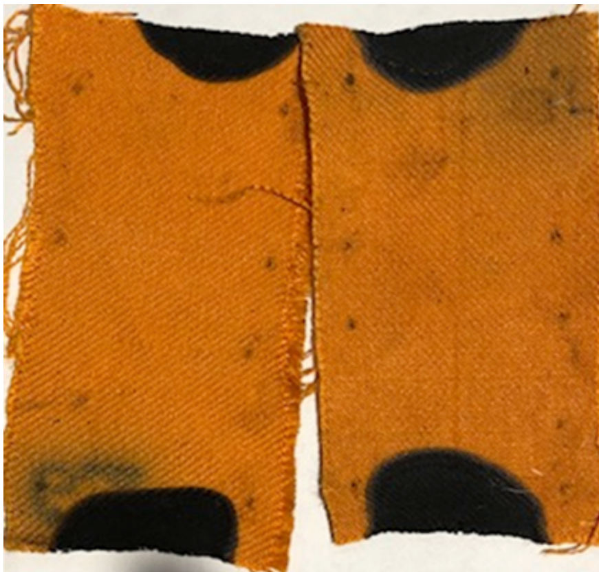
Рисунок 1 – Ткань из волокна Арселон после продолжительного воздействия огня
