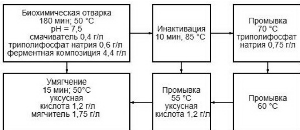
Рисунок 2 – Схема биохимического способа получения отваренного котонизированного волокна
