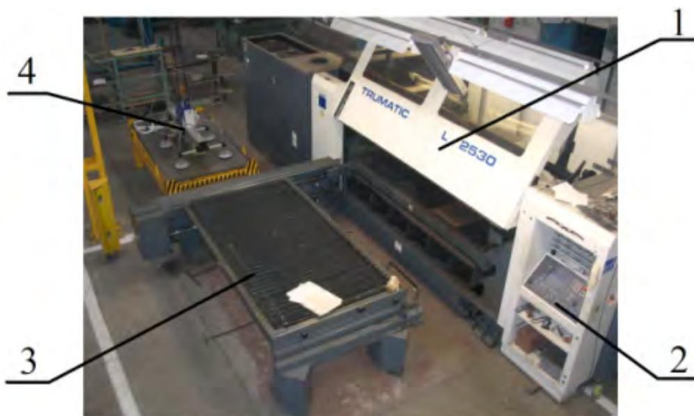
Рисунок 1 – Внешний вид комплекса лазерной резки TRUMATIC L2530:
