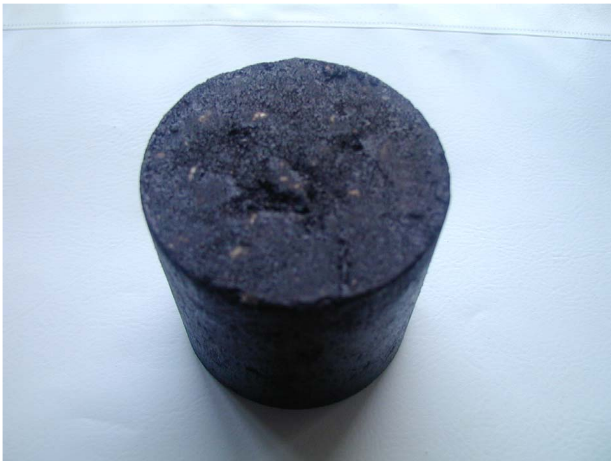
Рисунок 2 - Образец асфальтобетонной смеси стандартного состава
