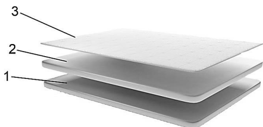
Рисунок 2 – Структура слоёв готового изделия: 1 – подложка, 2 – биоразлагаемый слой, 3 – нановолокнистый слой Figure 2 – Layer structure of the finished product: 1 – substrate, 2 – biodegradable layer, 3 – nanofibrous layer
