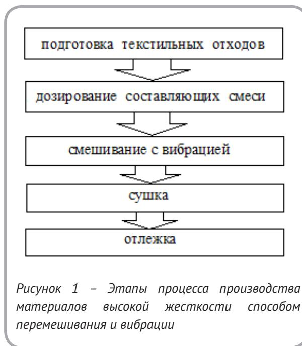
*Рисунок 1 – Этапы процесса производства материалов высокой жесткости способом перемешивания и вибрации*
