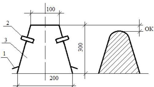
Рисунок 4 – Определение удобоукладываемости смеси по осадке конуса: 1 – опоры; 2 – ручки; 3 – конус; OK – осадка конуса
