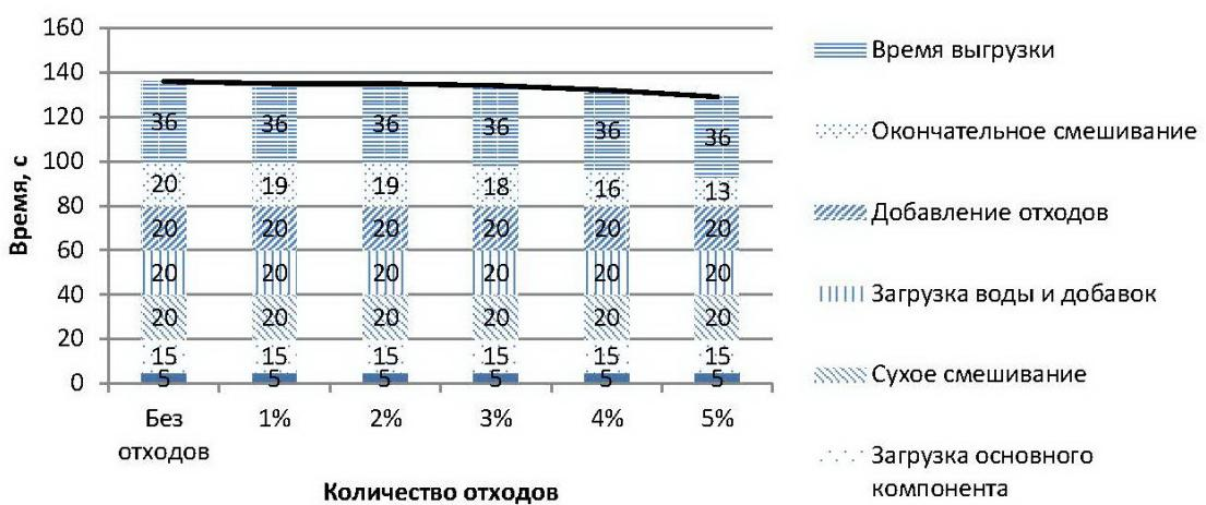
Рисунок 3 – Цикл смешивания смеси при добавлении отходов ОАО «Белвест»
