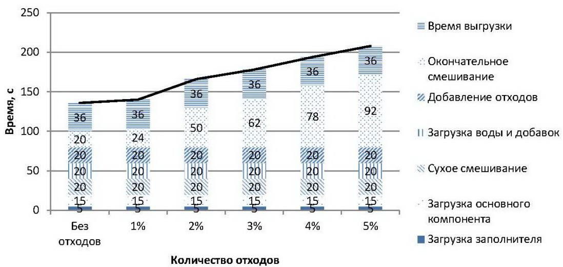
Рисунок 2 – Цикл смешивания смеси при добавлении отходов ОАО «Витебские ковры»
