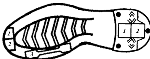
Рисунок 2 – Места вырубki образцов по ГОСТ 7926-75:
