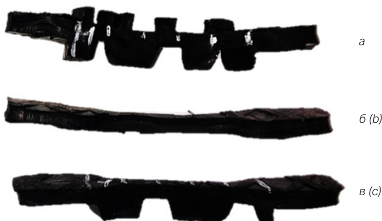
Рисунок 5 – Профиль подготовленных образцов к испытанию, на примере образца № 6:
