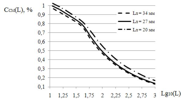
Рисунок 3 – Градиант неровноты смешивания, полученный для льнохлопковой ленты, при различной средней длине волокон компонентов
