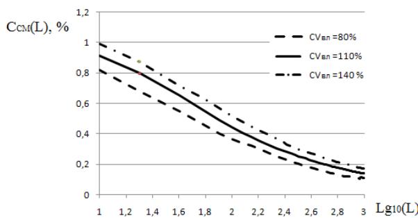
Рисунок 2 – Градиант неровноты смешивания, полученный для льнохлопковой ленты, при различных значениях коэффициента вариации льняного волокна
