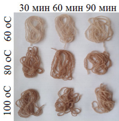
Рисунок 5 – Результат окрашивания шерстяной пряжи при разных режимах экстрагирования Figure 5 – The result of dyeing wool yarn under different extraction conditions
