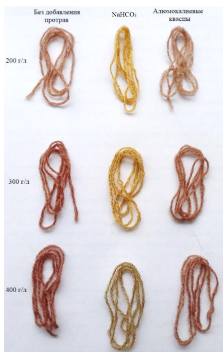
Рисунок 7 – Результат окрашивания шерстяной пряжи при разной концентрации виноградных выжимок в растворе Figure 7 – The result of dyeing wool yarn with different concentrations of grape pomace in the solution
