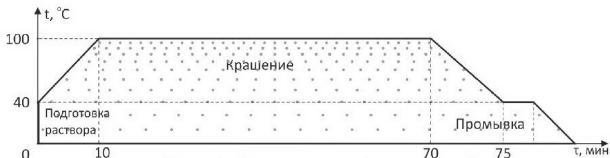
Рисунок 2 – Схема крашения традиционным способом
