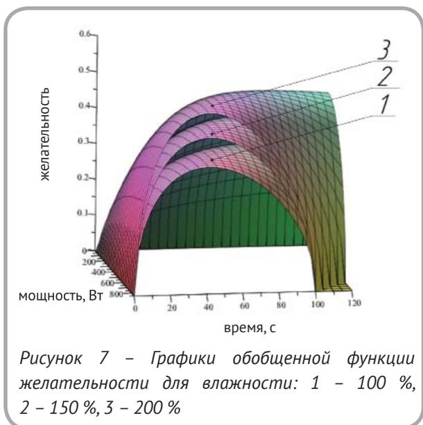
Рисунок 7 – Графики обобщенной функции желательности для влажности: 1 – 100 %, 2 – 150 %, 3 – 200 %
