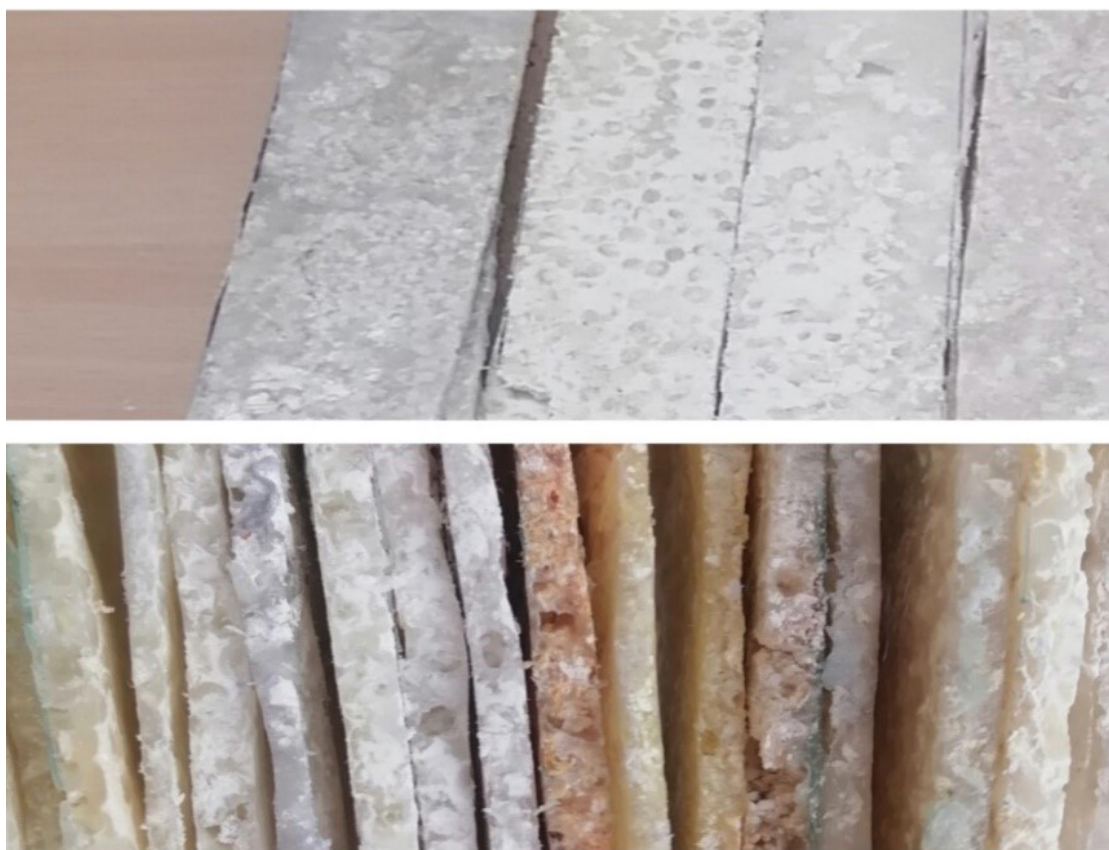
Рисунок 1 – Образцы измельченного полипропилена с антипиренами
