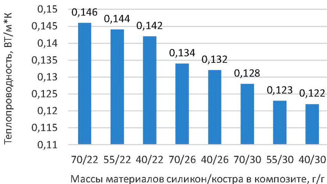
Рисунок 2 – Зависимость коэффициента теплопроводности композита от масс материалов матрицы и наполнителя
