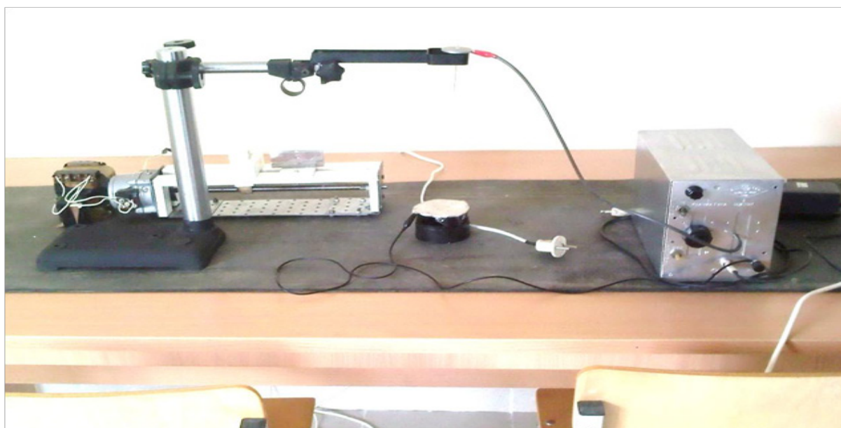
Рисунок 2 – Экспериментальная установка для формирования наноразмерных волокон
