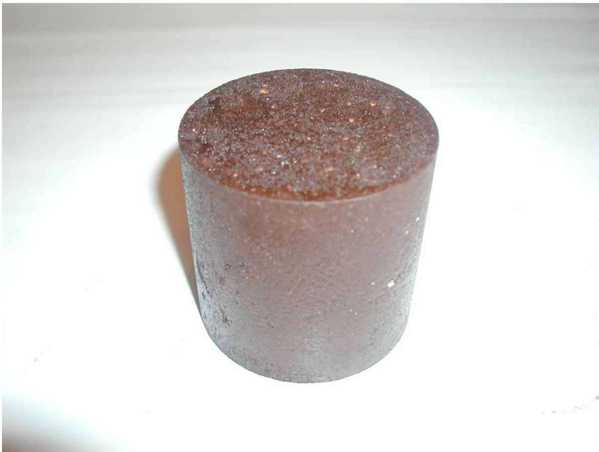
Рисунок 3 - Образец асфальтобетонной смеси с добавкой шлама ТЭЦ
