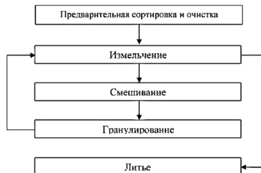
Рисунок 3 – Схема технологии получения материалов для подошв обуви из вторичного модифицированного ППУ
