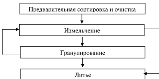
Рисунок 2 – Схема технологии получения материалов для подошв обуви из вторичного ППУ без добавок
