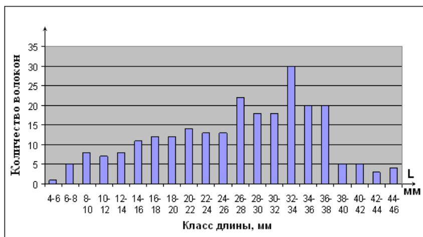
Рисунок 3 – Штапельная диаграмма распределения хлопковых волокон в волокнистой ленточке по длине при частоте вращения дискретизирующего барабанчика  $n_{д.б} = 5500 \text{ мин}^{-1}$
