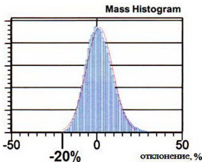
Рисунок 5 – Гистограмма отклонений масс отрезков армированных нитей линейной плотности 16,7 текс
