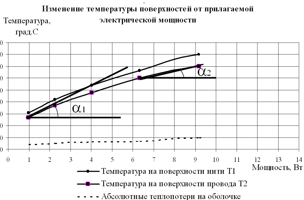
Рисунок 4 – Зависимость температуры на поверхности нити и на оболочке изолирующего материала от величины прилагаемой мощности тока
