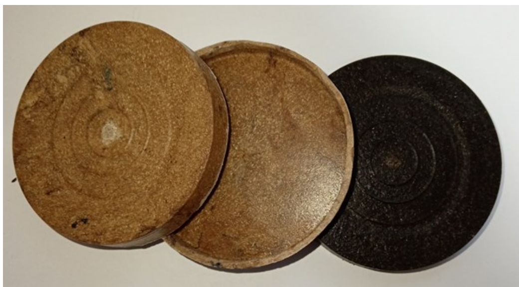
Рисунок 8 – Экспериментальные образцы изделий из композита на основе ПЛА с ДМ (коричневый) и ГЛ (черный)
