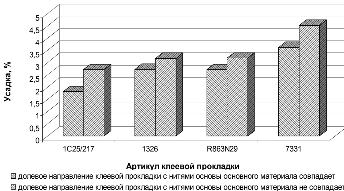
Рисунок 1 – Зависимость усадки клеевого пакета после дублирования от соотношения долевого направления прокладки с нитями основы и утка эластичной ткани арт. 3210
