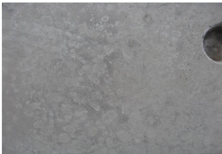
Рисунок 3 – Образец поверхности бетонной плиты после применения в качестве смазки для разборной стальной опалубки эмульсии на основе экстракта нефтяного, жирной кислоты и неанола. Концентрат эмульсола подвергнут ультразвуковой обработке
