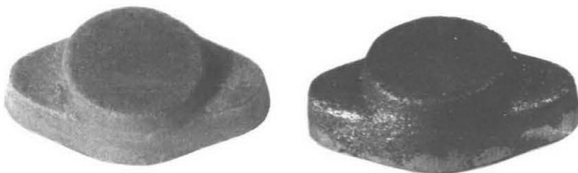
Рисунок 4 – Литейная SLS-модель на основе кварцевого песка и термопластичного полимерного связующего (слева) и чугунная отливка, изготовленная по этой модели методом литья в песчаные формы
