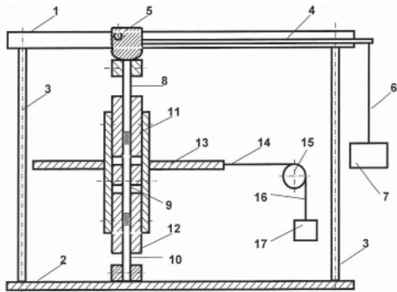
Рисунок 1 – Схема трибометра
