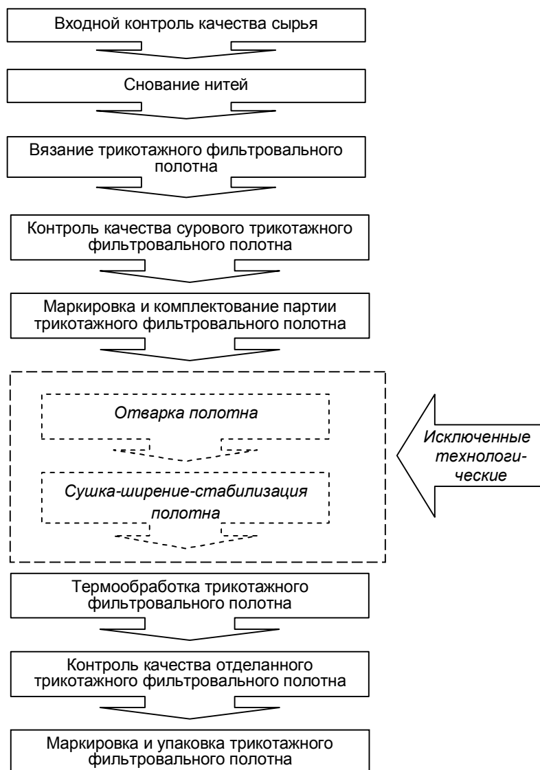
Рисунок 1 – Технологический процесс производства многослойных фильтровальных трикотажных материалов для аэрозолей
