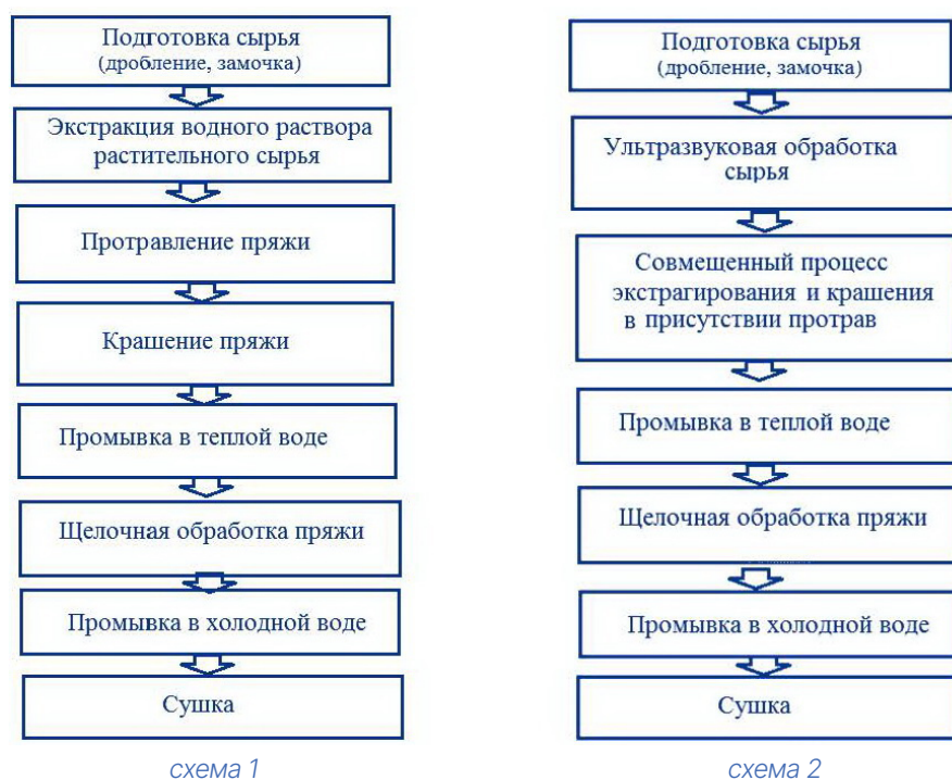
Рисунок 1 – Схемы процесса крашения шерстяной пряжи природными красителями Figure 1 – Schemes of the process of dyeing wool yarn with natural dyes
