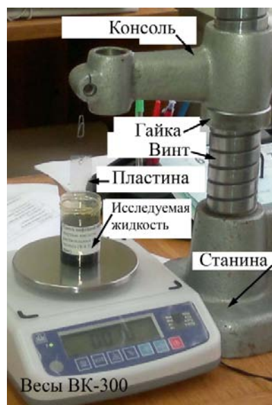
Рисунок 2 – Экспериментальная установка по определению коэффициента поверхностного натяжения методом пластины Вильгельми
