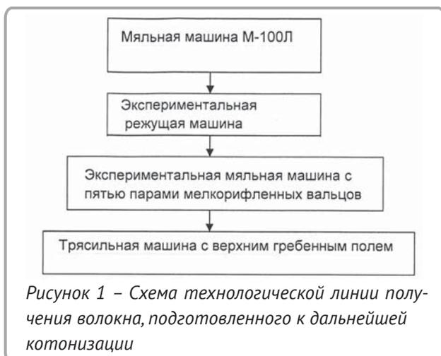
Выработка волокна, подготовленного к дальнейшей котонизации, производилась следующим образом.
