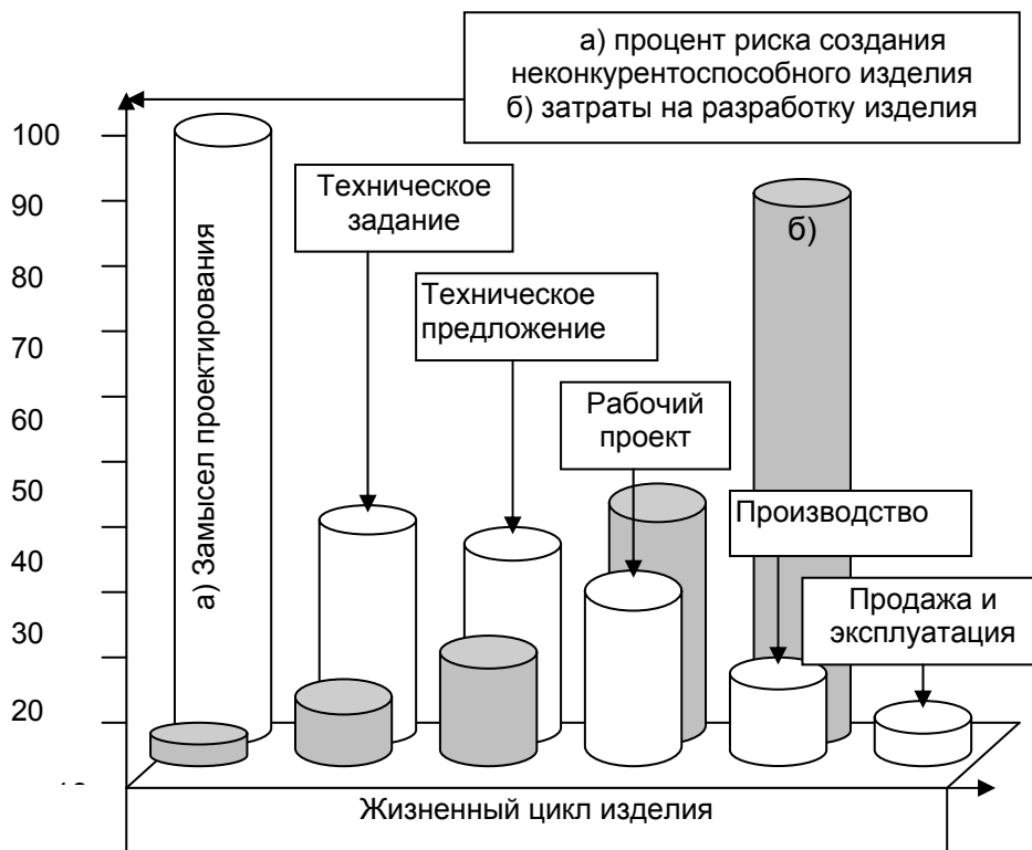
Рисунок 2 – Риск (а) и затраты (б) на создание нового металлорежущего станка на этапах его жизненного цикла
