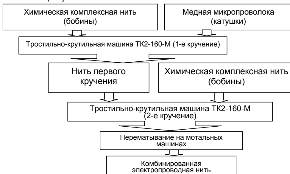
Рисунок 1 - Технологическая цепочка получения комбинированных электропроводящих нитей на тростильно-крутильном оборудовании
