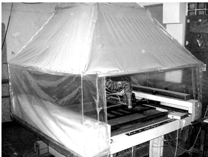
Рисунок 3 – Опытно-промышленная установка лазерного раскроя
