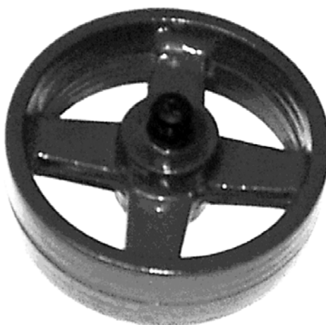
Рисунок 2 – Типовой представитель модели 4 группы сложности, изготовленный методом ТПС
