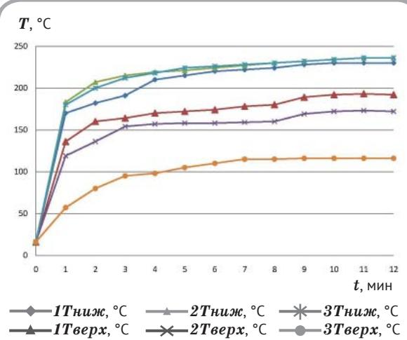
Рисунок 2 – Процесс нагревания поверхностей образцов
