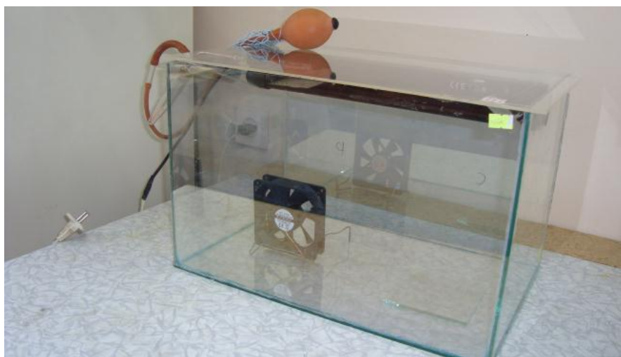
Рисунок 5 – Ввод химических веществ в камеру при помощи распылителя
