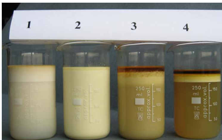
Рисунок 3 – 1 – 10% эмульсия на основе эмульсола ВЛВ; 2 - 10% эмульсия на основе масла ВД-3 и жирных кислот; 3 - 10% эмульсия рапсового масла в воде с триэтаноламином в качестве эмульгатора; 4 - 10% эмульсия рапсового масла в воде с неололом АФ9-12 в качестве эмульгатора
