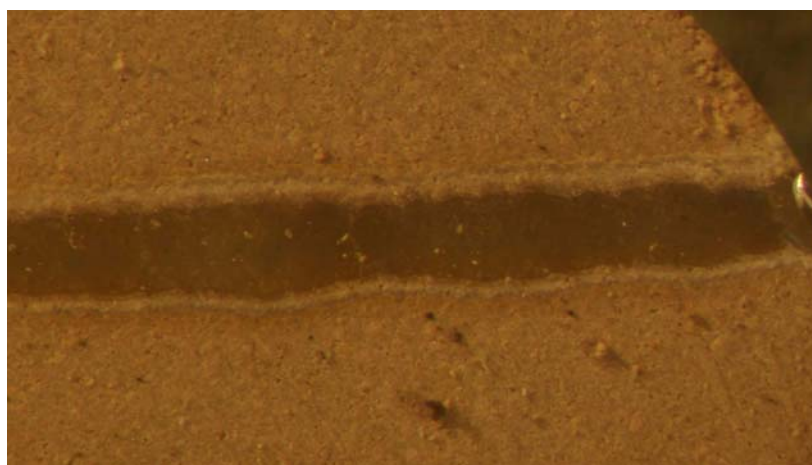
Рисунок 3 – Поверхность компактного образца, изготовленного из порошка Al_2O_3 плакированного Co, после воздействия лазерного излучения: \lambda = 1.06 \text{ мкм} , плотность мощности излучения q = 2.8 \text{ кВт/см}^2 , скорость перемещения образца v = 1 \text{ см/с}
