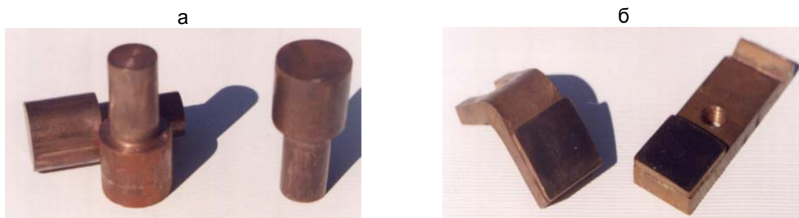
Рисунок – Электроды для контактной сварки (а), контактодержатели с припаянными облицовочными платинами (б)
