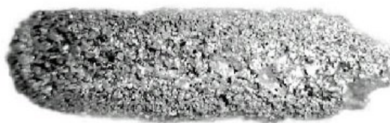
Рисунок 3 – Спечено/переплавленная структура титанового стержня (шлиф) Figure 3 – Sintered-remelted structure of titanium rod (section)
