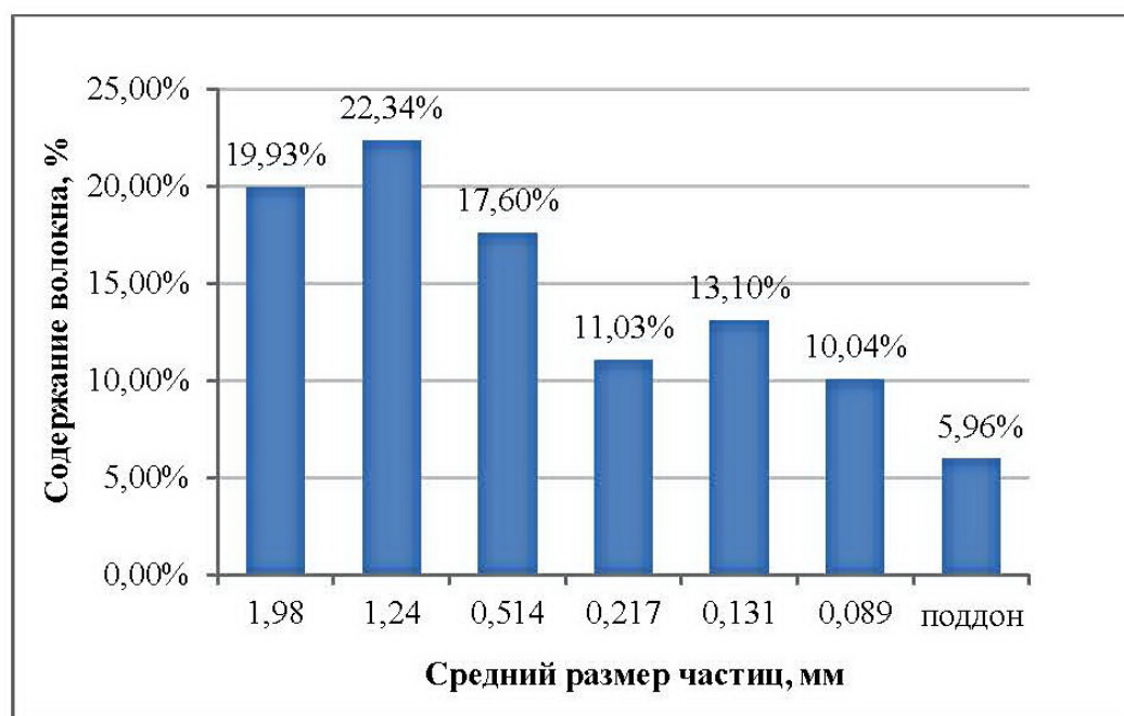
Рисунок 2 – Фракционное распределение древесного волокна на ситах
