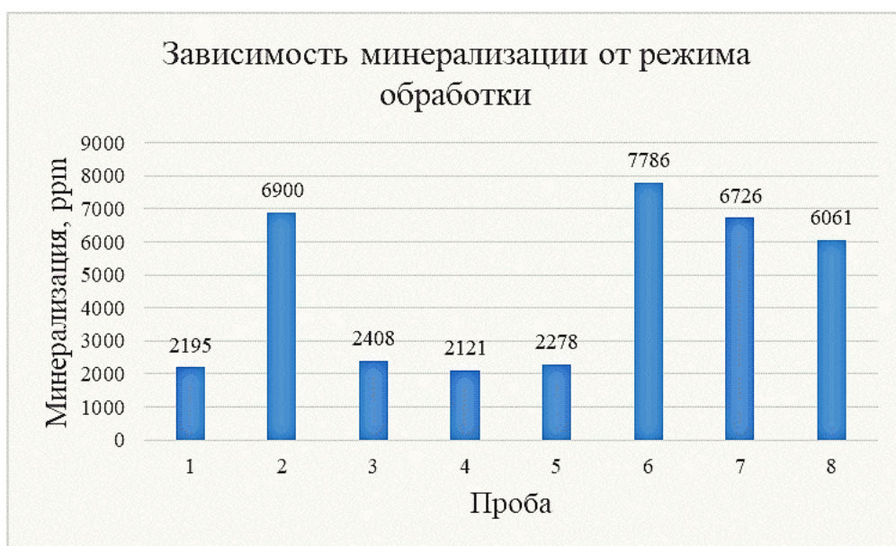
Рисунок 4 – Графические зависимости значения показателя качества сточных вод текстильного производства «Минерализация» (ПДК = 1000 ppm) от режимов обработки: 1–8 – варианты воздействия на СВ, описанные в методике экспериментальных исследований
