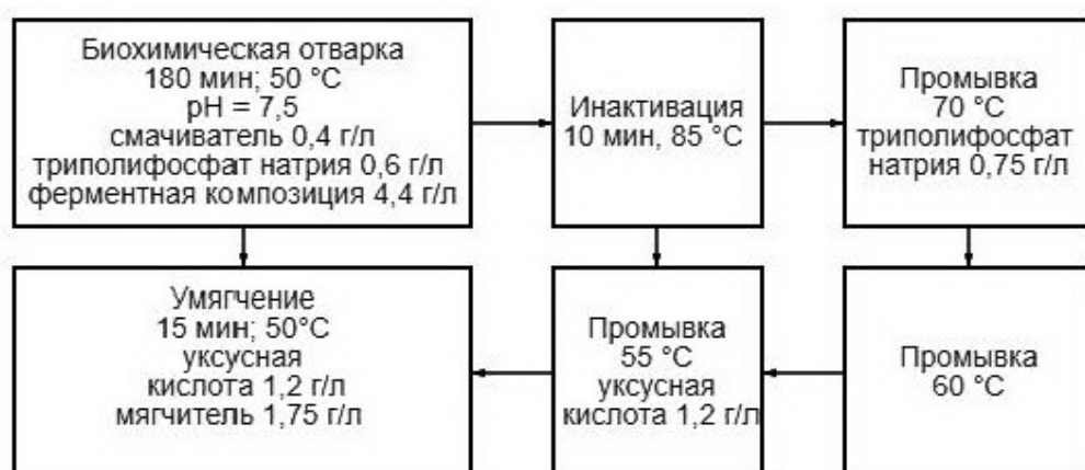
Рисунок 2 – Схема биохимического способа получения отваренного котонизированного волокна
