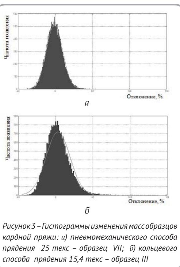
Рисунок 3 – Гистограммы изменения масс образцов кардной пряжи: а) пневмомеханического способа прядения 25 текс – образец VII; б) кольцевого способа прядения 15,4 текс – образец III
