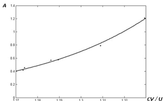
Рисунок 4 – Зависимость асимметрии от отношения квадратической неровности к линейной для образцов кардной пряжи
