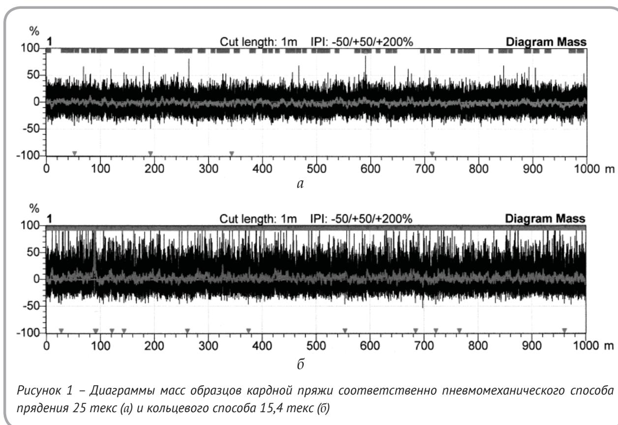
Рисунок 1 – Диаграммы масс образцов кардной пряжи соответственно пневмомеханического способа прядения 25 текс (а) и кольцевого способа 15,4 текс (б)
