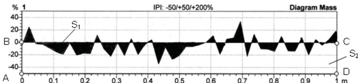
Рисунок 2 – Схема для расчета линейной неровноты продукта прядения
