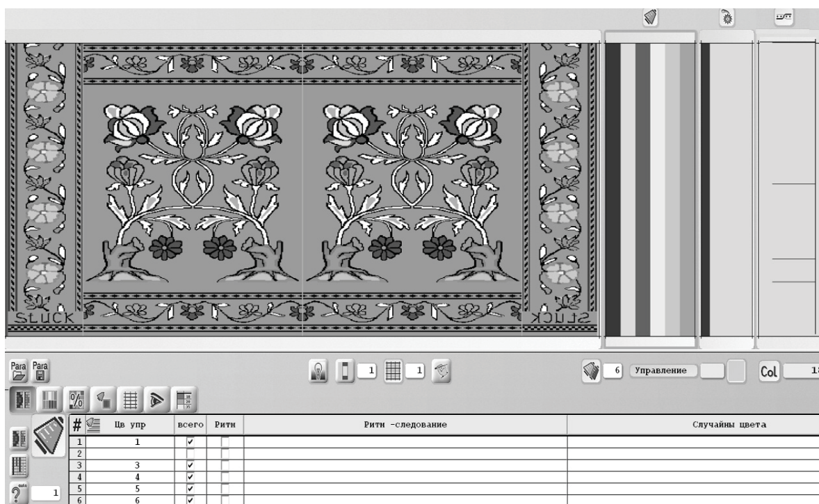
Рисунок 9 – Программирование работы челноков и остановки в кайме пояса
