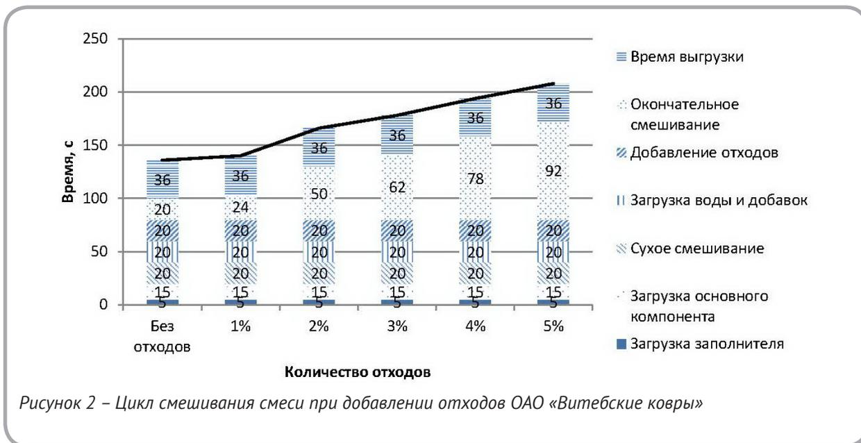
Рисунок 2 – Цикл смешивания смеси при добавлении отходов ОАО «Витебские ковры»
