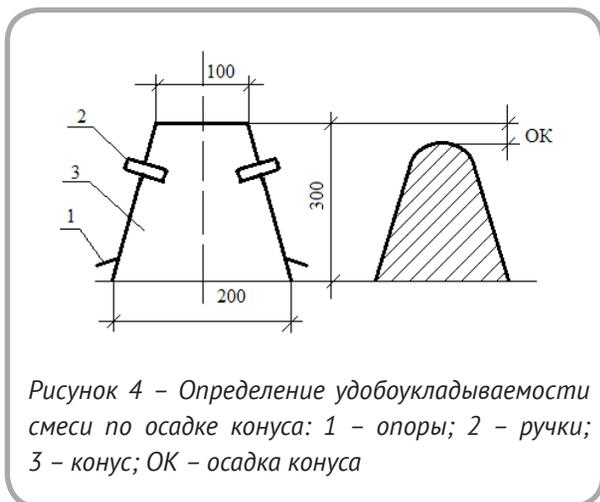
Рисунок 4 – Определение удобоукладываемости смеси по осадке конуса: 1 – опоры; 2 – ручки; 3 – конус; ОК – осадка конуса
