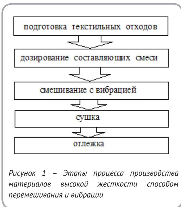
Подготовка текстильных отходов заключается в их измельчении. Измельчение осуществляется на дробилке роторной ДР-185. Принцип работы следующий: в загрузочный бункер загружаются коротковолокнистые отходы, измельчение которых происходит между вращающимися ножами ротора и неподвижными ножами, установленными в камере резания дробилки. Максимальный
