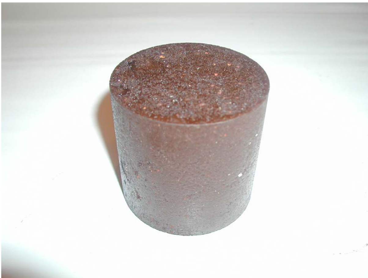
Рисунок 3 - Образец асфальтобетонной смеси с добавкой шлама ТЭЦ
