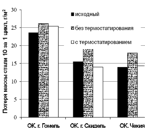
Рисунок 4 – Влияние УЗК обработки на защитные свойства ОК при воздействии сернистого ангидрида
