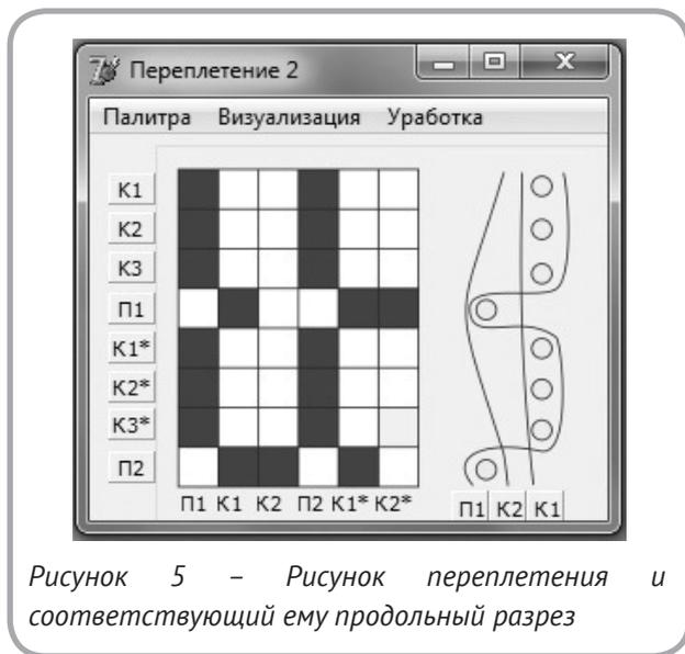
Рисунок 5 – Рисунок переплетения и соответствующий ему продольный разрез
