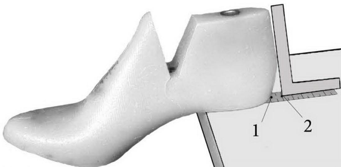
Рисунок 2 – Изображение методики измерения сдвига стельки в пяточной части колодки
