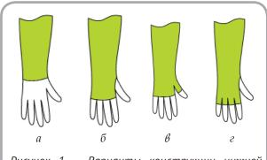
Рисунок 1 – Варианты конструкции нижней части компрессионного рукава
