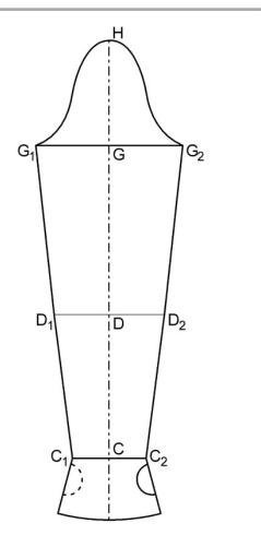
Рисунок 5 – Конструкция детали компрессионного рукава, нижняя часть которого выполнена по варианту 2
