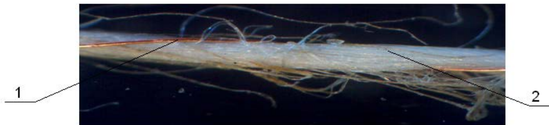
Рисунок 3 – Комбинированная льносодержащая электропроводящая нить линейной плотности 47 текс под микроскопом:
