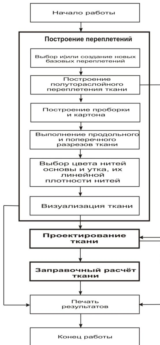
Рисунок 1 – Блок-схема САПР для проектирования полутораслойных тканей
