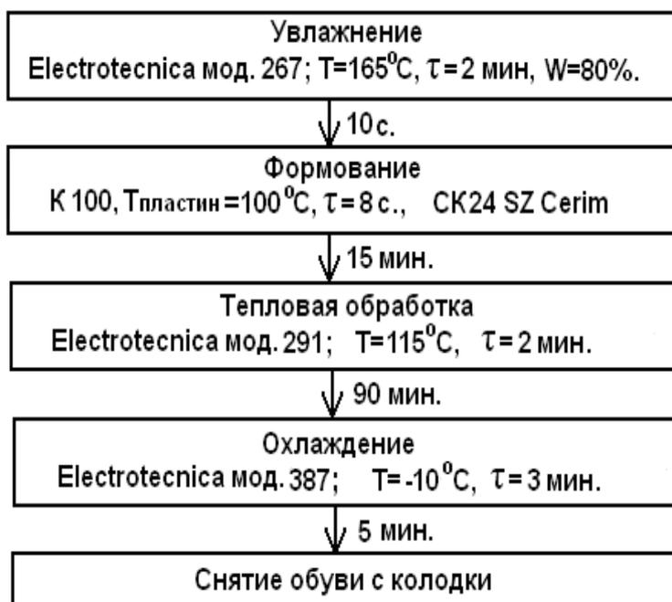
Рисунок 1 – Схема технологического процесса производства обуви
