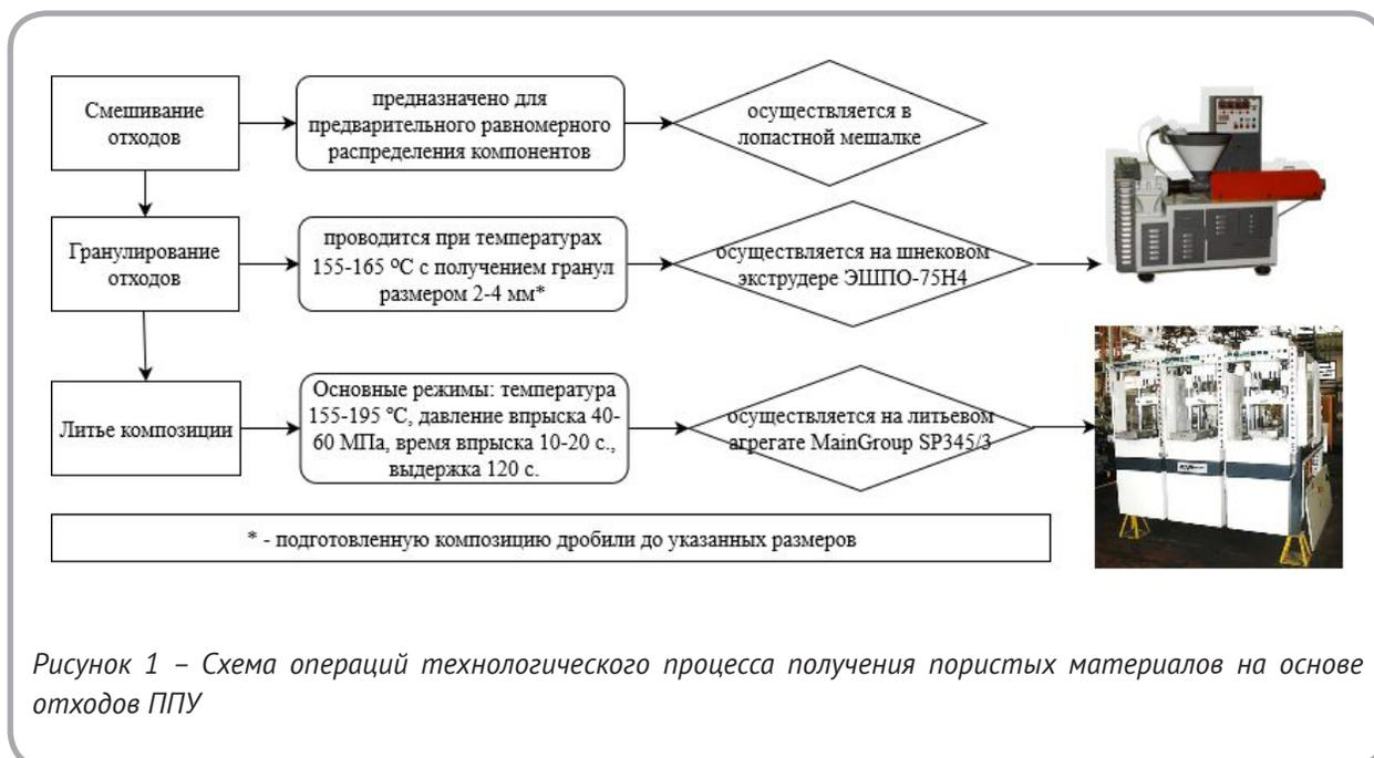
Рисунок 1 – Схема операций технологического процесса получения пористых материалов на основе отходов ППУ
