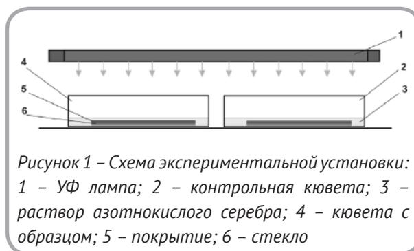
Рисунок 1 – Схема экспериментальной установки: 1 – УФ лампа; 2 – контрольная кювета; 3 – раствор азотнокислого серебра; 4 – кювета с образцом; 5 – покрытие; 6 – стекло
