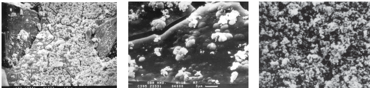
Рисунок 5 – Микрорельеф поверхностной пленки (а) и отдельных ее участков (б, в) на обработанном методом НХО хромалмазном покрытии с преимущественным содержанием оксидов молибдена (б) и титана (в)
