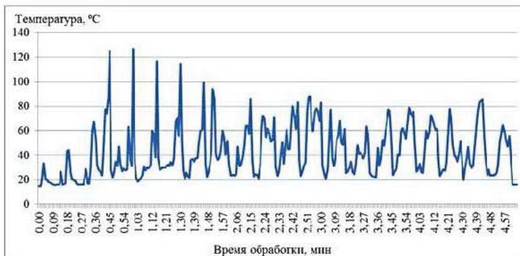
Рисунок 11 – Зависимость значений температуры от времени при черновой и чистовой обработке сферической поверхности детали
