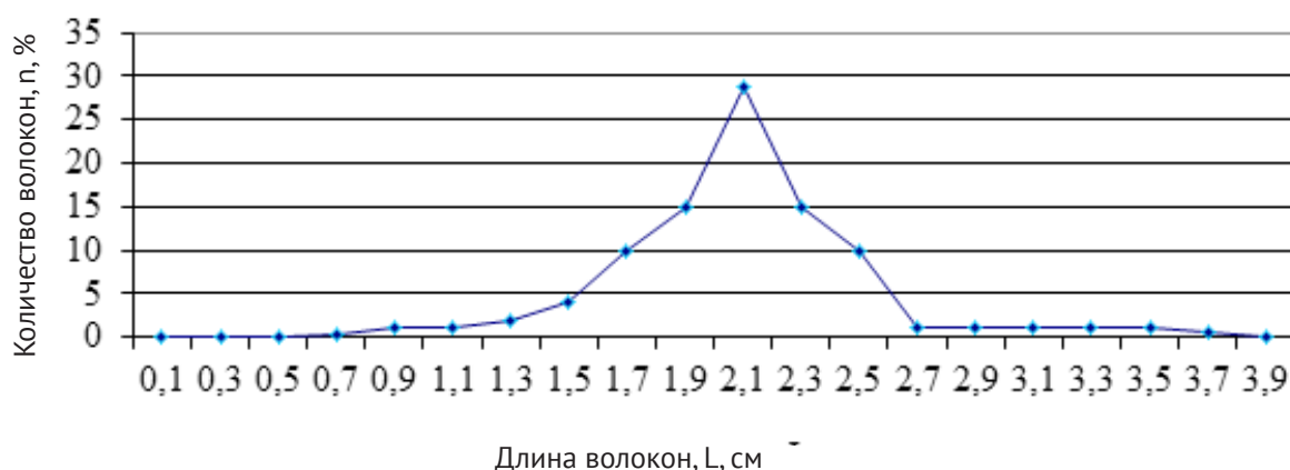
Рисунок 1 – Диаграмма распределения длин волокон в отходах кноп стригальный после стрижки
