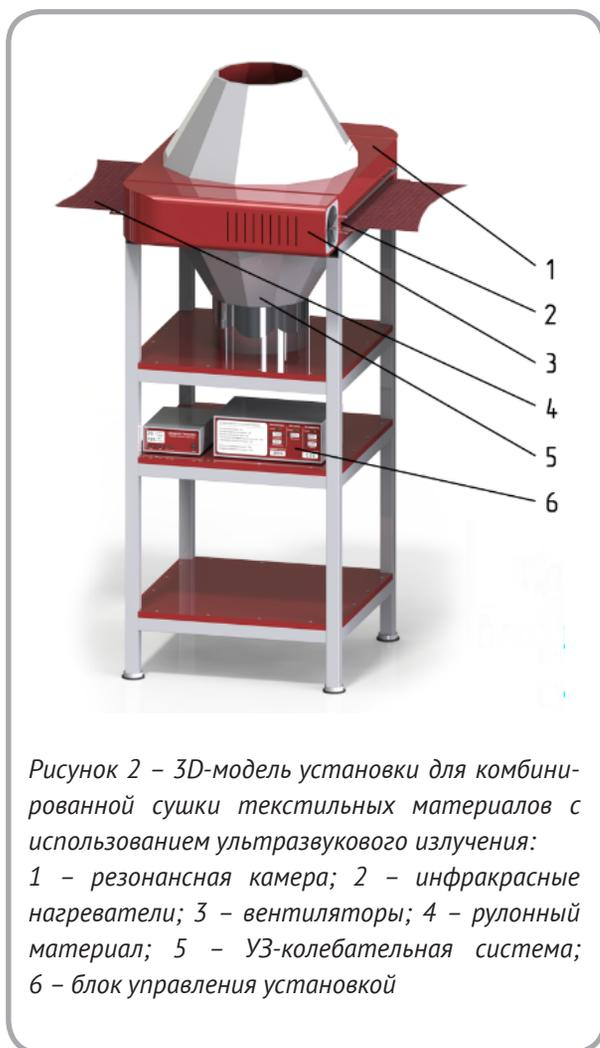
Рисунок 2 – 3D-модель установки для комбинированной сушки текстильных материалов с использованием ультразвукового излучения:
